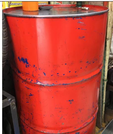
**Fotografía 1.** Caneca metálica de 55 galones para acopio de aceite usado
