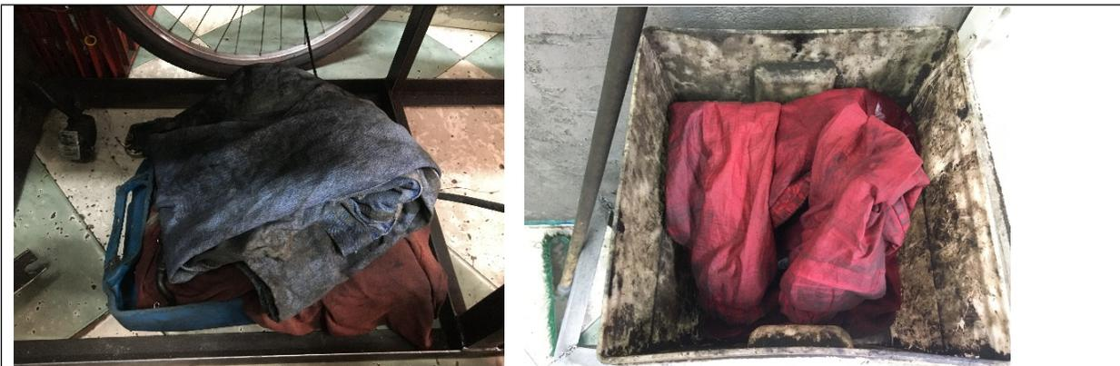
**Fotografía 5 y 6.** Almacenamiento de residuos peligrosos (Sólidos Contaminados con Aceite (material textil, cartón, plástico, EPPS)) sin contenedor definido y sin etiquetar o rotular.
