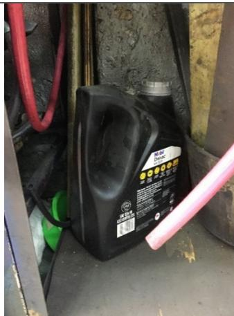
**Fotografía 4.** Almacenamiento de residuos peligrosos (Recipientes Contaminados con Aceite) fuera del contenedor y sin etiquetar y rotular.
